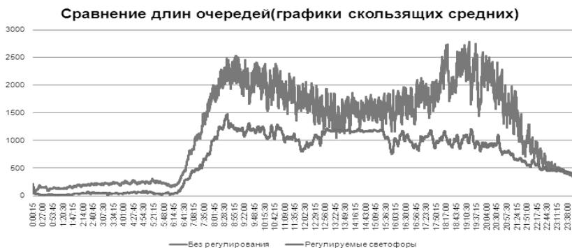
**Рис. 2.** Сравнение эффективности предлагаемой модели с моделью фиксированных времен переключения светофоров
