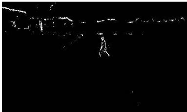
**Рис. 5.** Выделенные границы препятствий, расположенных выше плоскости дороги
