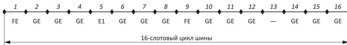
Рис. 2 Пример распределения ресурсов слотовой шины
