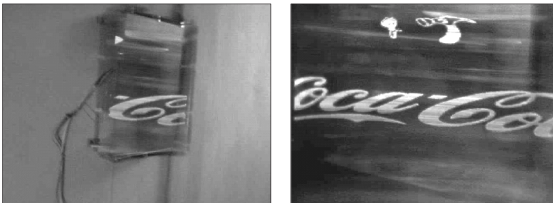
Рис. 1 Фотографии одного и того же изображения, формируемого в прикрепленном к стене колеблющемся зеркале линейкой модулируемых по яркости светодиодов. Правая фотография сделана фотоаппаратом, находящимся на меньшем расстоянии от зеркала, чем левая
